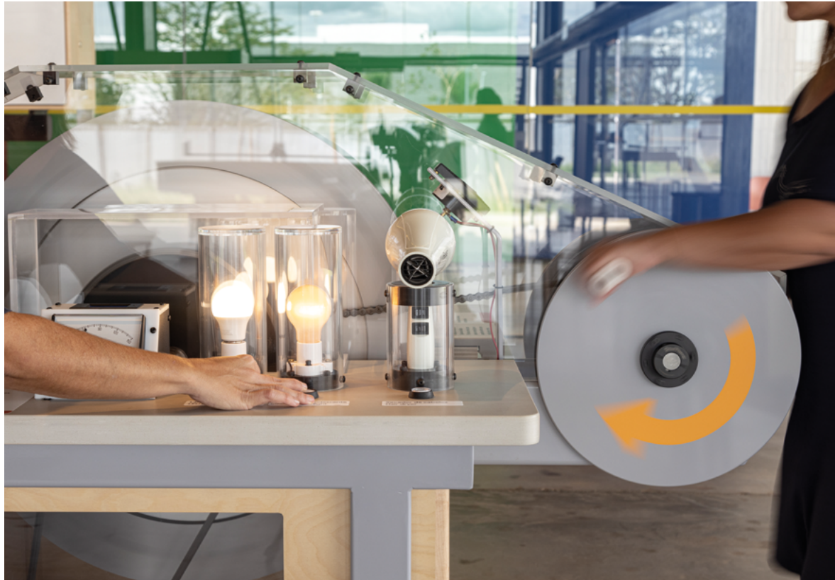
Volante gerador Flywheel Generator
